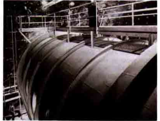
Nötrinoların algılanması çok zordur. Toprağın derinliklerine gömülü olarak yapılmış çok büyük yapılar kurmak gerekir. Fotoğrafta, Güney Dakota'da, Lead'deki Homestake altın madeninde kurulmuş bir Amerikan alıcısı görülüyor.
