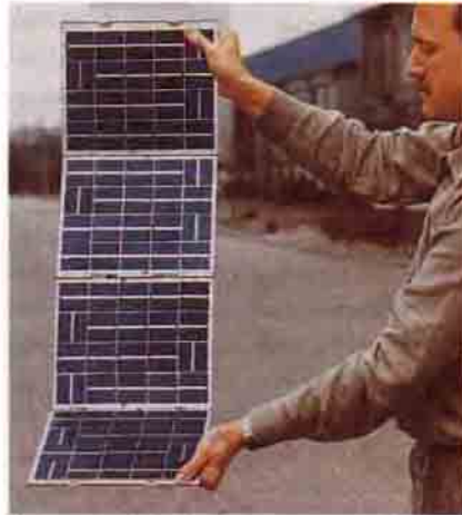
İletişimde elektrik elde etmek amacıyla kullanılan katlanabilir PV panelleri.
