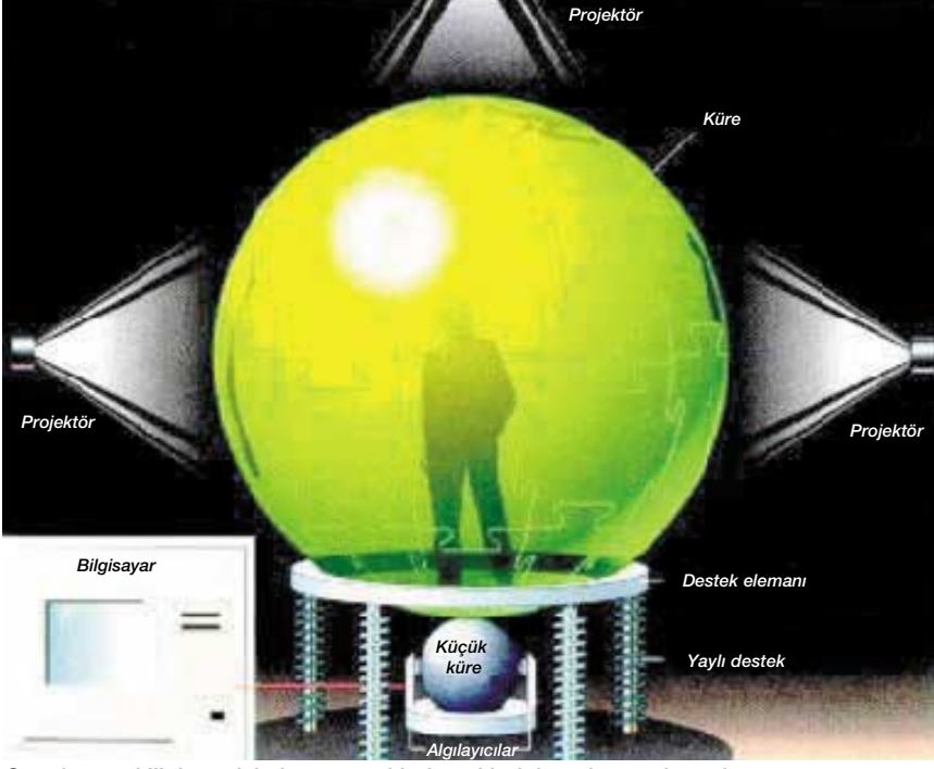
Sanal gerçeklik küresiyle hava yastıklı desteklerinin çalışma sistemi
