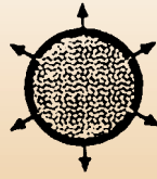
İlacın polimer zardan difüzlendiği rezervuar sistem.
