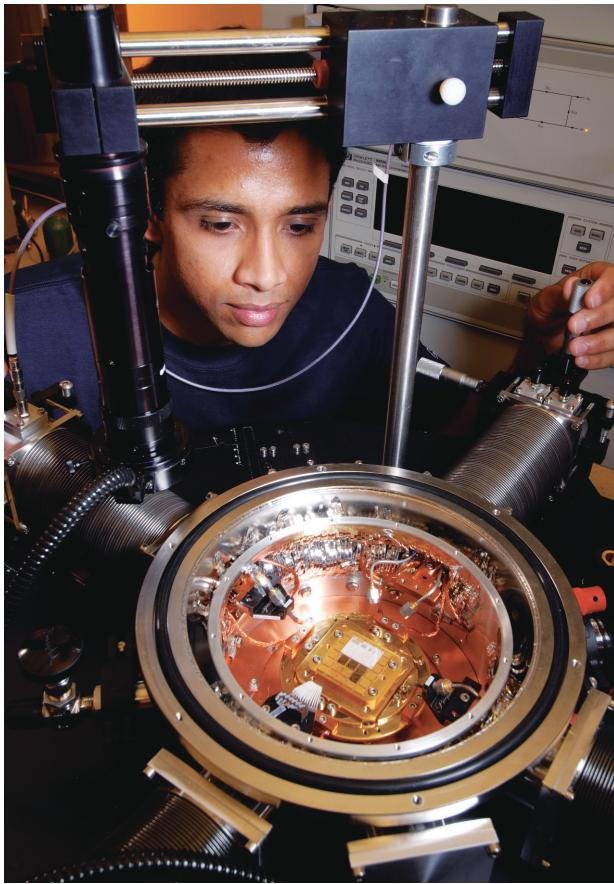
IBM ve Georgia Teknoloji Enstitüsü'nün mutlak sıfır yakını sıcaklıklarda çalıştığı silikon transistörler, günümüzde satın alabileceğiniz en güçlü işlemci üzerinden yaklaşık 150 kat daha hızlı çalışıyor.
