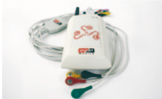
Türkiye'de tasarlanıp üretilen bu EKG aygıtı GSM üzerinden veri aktarımı yapıyor.
