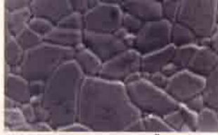
Şekil 2: Ekstrüzyon Yöntemiyle Üretilmiş Parçaların SEM Mikrografı.
