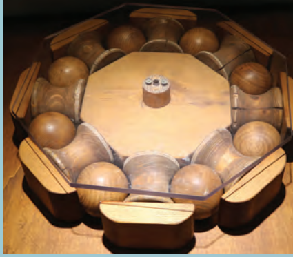
İtalyan bilgin ve sanatçı Leonardo da Vinci'nin çizimine bağlı kalınarak inşa edilen bilyeli rulman
