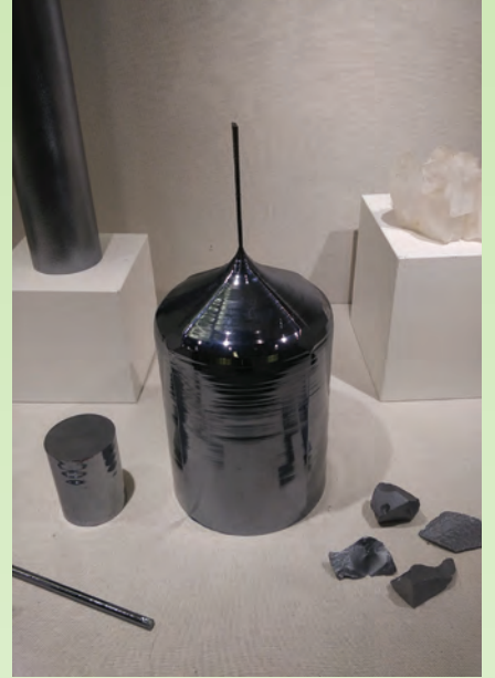
Kum eritilerek “ingot” adı verilen saf silikon külçeye dönüştürülüyor.
