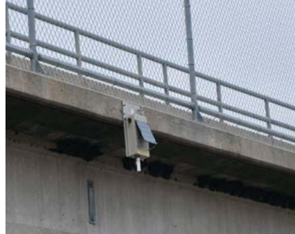
Iowa Sel Merkezi'nde geliştirilen güneş enerjili su seviyesi sensörü
