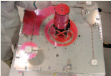
BİLSAT'ın "uzaya bakan" yüzündeki pasif ısı kontrol kaplamaları. Görünen kaplamanın rengi sizi yanıltmasın, pembe katman fırlatmanın hemen öncesinde çıkartılmıştır.
