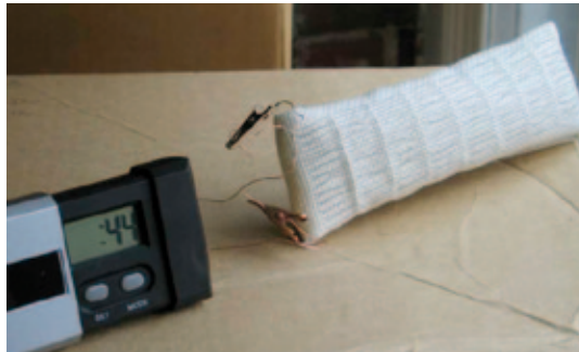
Küçük bir çalar saati çalıştıran, fotovoltaik tel kullanılmış örgü yapısı (DeCristofano, 2009)
