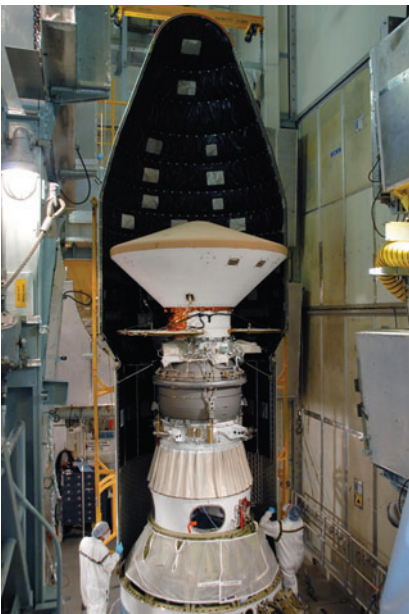
Lokheed Martin şirketinin tasarlayıp ürettiği Phoenix uzay aracı, katlanıp koruyucu kapsüle konduktan sonra roketin burnundaki bölme yerleştirildi.
