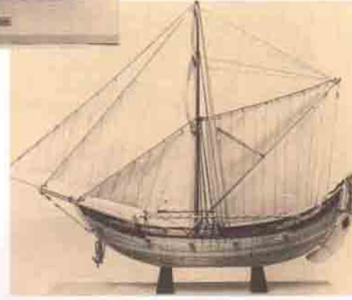
Yunanlı ve Türk tekne ustalarının ortak ürünü olan İnebolu küfütü. Üstteki resim uygulama modelini gösteriyor. Taş kayığı da denen bu önce-kabuk türü tekne tipinin yapımı 20. yüzyıl başlarına dek sürmüştür.
