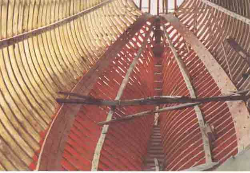
Tekneü tersanesinde yapılmakta olan bir teknede lamine parçalardan oluşan kaburgalar (karşı sayfa) ve iskeleti içeriden destekleyen boyuno elemanlar (1995).
