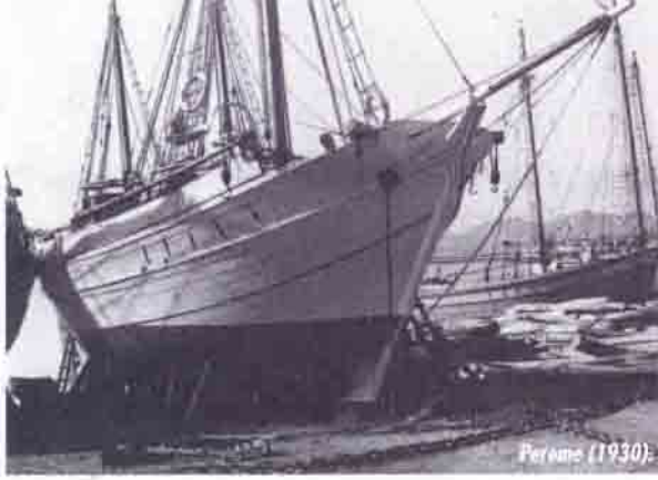
Yunanlı ve Türk tekne ustalarının ortak ürünü olan İnebolu küfütü. Üstteki resim uygulama modelini gösteriyor. Taş kayığı da denen bu önce-kabuk türü tekne tipinin yapımı 20. yüzyıl başlarına dek sürmüştür.
