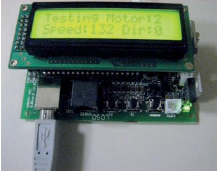
Sabancı Üniversitesi'nde geliştirilen mekatronik eğitimi amaçlı gömülü bilgisayar SuboardII. Detaylı bilgi için: http://fens.sabanciuniv.edu/suboard
