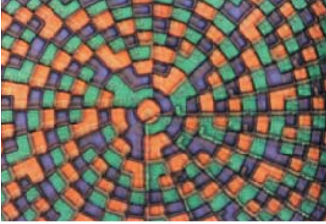
Dairesel noktacı dizimli bir CMOS yongasına ait ayrıntı mikrofotografı. Noktacıklar 0,7 mikrometre çaplı. Bayer CFA renk motifinin, dairesel dizilime nasıl uyarlandığını örneklemesi açısından ilginç bir fotoğraf. Dairesel dizilim, özellikle, göz için yapay ağtabaka üretimi çalışmaları için önemli.
