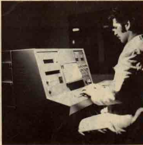
Ajans - Türk'ün son sistem doğrudan film üzerine dizgi yapan elektronik soğuk dizgi makinası.
