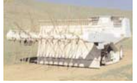
Mayın temizlemede kullanılan bir başka araç da "zincirli kamçı" olarak bilinen bu zırhlı araçtır. Bu araç mayınlı bölgedeki AT mayınlarının tamamını patlatırken, AP mayınlarının % 10'unu iskalar.
