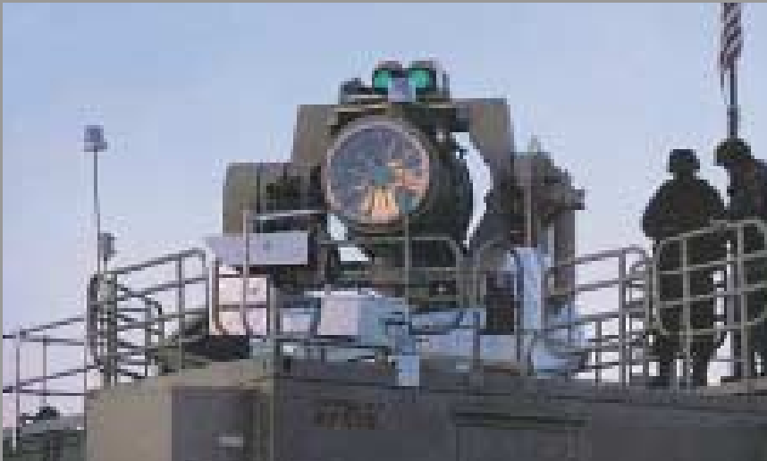
Ateş kontrol radarı, yaklaşan bir Katyuşa roketini saptar ve yörünge verilerini Tactical High Energy Laser ışın yöneticisine gönderir.
