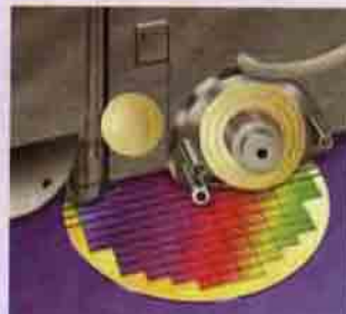
Disklerin üzerindeki yongalar yüksek hızlı ve su soğutmalı elmas testerelele kesilerek kaplarının içine konmaya hazır hale getirilir.
