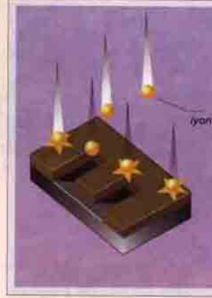
Yonganın üzerine koruyucu bir polisilikon tabaka yerleştirilir
