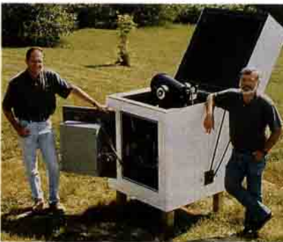
Jerry Gunn ve Charles Lamb'ın yaptığı uzaktan kumandalı robot gözlemevi. Gunn ve Lamb, gözlemlerini bu gözlemevi sayesinde 50 kilometre uzaktaki evlerinin rahatında yapıyorlar.
