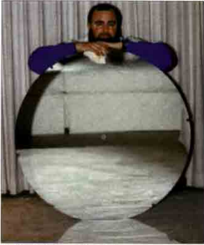
Solda: Bir Amatör teleskop yapımcısı Steve Swayze, kendi yaptığı 1 metre çaplı parabolik teleskop aynasıyla birlikte. Ortada: Swayze'nin kendi yaptığı teleskop. Sağda: Swayze'nin yaptığı bu dev boyutlardaki dürbün, ödül almış. İlginçtir ki, bu dürbün bir yıldız partisine götürülürken çalınmış!
