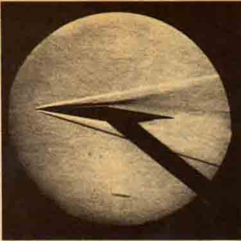
İki tarafı kama şeklinde bir kanadın Schlieren fotoğrafı. Hipersonik tünelde Mach 6 hızla giderken alınmıştır.
