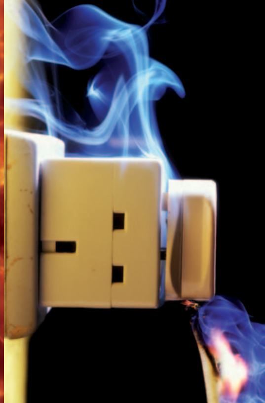
Kablolarda, elektrik soketlerinde ve anahtarlarında yangına direnen polimerlerin kullanılmasıyla yangınlar önlenebilir veya zararları azaltılabilir.
