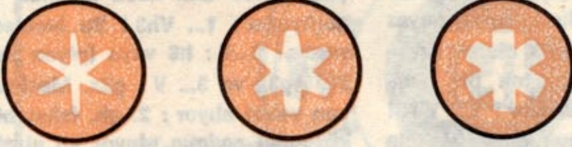
NO. 2. YILDIZ KESİTLİ BOŞLUK İLE DONATILMIŞ ROKET MOTORU
