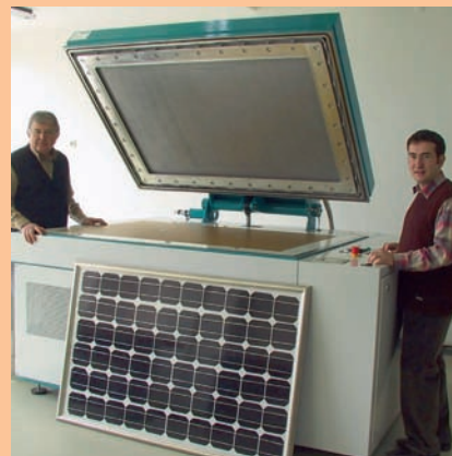
E.Ü. Güneş Enerjisi Enstitüsü'nde güneş pilleri laminasyon makinesiyle kaplanarak dış etkilere dayanıklı hale getiriliyor.
