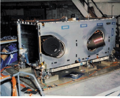
İtki sistemleri, uyduların durum kontrolü için kullanılır. Aynı uyduda üzerinde birkaç farklı güçte itki sistemi bulunabilir. Bu sistemlerin güçleri, çalışma ilkelerine göre sınıflandırılır. Katı yakıtlı itki sistemleri (solda ve ortada), döner tekerlekli itki sistemlerine (sağda) göre daha güçlüdür.
