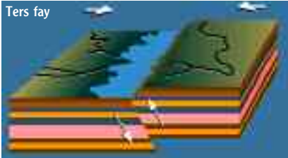
Şekil 1 Wenchuan depremi, hint levhasının avrasya levhasına yaklaştığı alanda meydana gelen kabuk deformasyonunun bir sonucu olarak kuzeydoğu-güneybatı yönelimli bindirme (ters) fay üzerinde meydana geldi.
