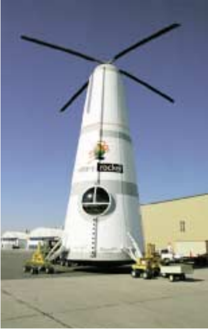
Rotary Roket Şirketi'nin uzay aracı Roton, tıpkı klasik bir roket gibi fırlatılıyor. Dünya yörüngesine ulaşmış, yükünü bıraktıktan sonra hızla atmosfere giriyor. Yere inerken aracın önündeki büyük pervaneler açılıyor ve araç tıpkı bir helikopter gibi iniyor.
