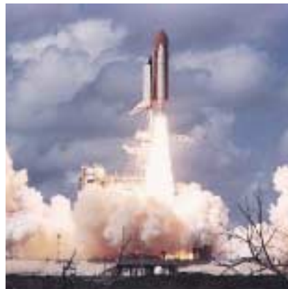
İlki 1981 yılında tamamlanan ve göreve başlayan uzay mekikleri, yeniden kullanılabilen, insanlı uzay araçlarıdır. Ne var ki tek aşamalı değillerdir. Kendi roket motorlarına ek olarak büyük bir sıvı yakıt tankı ve onun iki yanında yer alan ek katı yakıt roketleri bulunur. Tıpkı bir roket gibi kalkar ve uçak gibi inerler.
