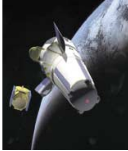
Rotary Roket Şirketi'nin uzay aracı Roton, tıpkı klasik bir roket gibi fırlatılıyor. Dünya yörüngesine ulaşmış, yükünü bıraktıktan sonra hızla atmosfere giriyor. Yere inerken aracın önündeki büyük pervaneler açılıyor ve araç tıpkı bir helikopter gibi iniyor.
