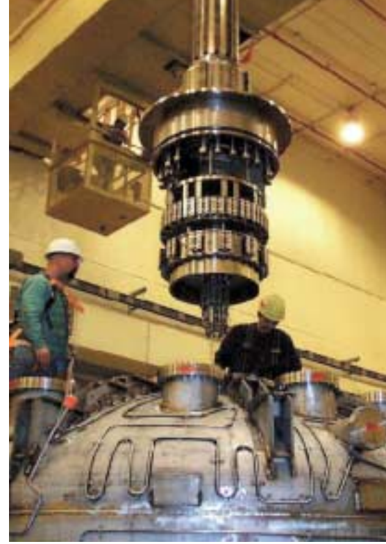
TAEK Nükleer Füzyon Laboratuvarı'nda geliştirilen STPC küresel tokamağının genel görünümü ve düzenegi geliştirilen Sinman'lar. Yalnızca 65 litre hacimli akı koruyucusuna sahip düzenek, şimdilik bir "model" sağlamanın ötesinde bir işleve sahip değil. Gene de merkezi bir mıknats çubuğuna gerek bırakmayan plazma enjeksiyonuna dayalı orijinal tasarımı, dünyada yürütülen çok daha ileri teknolojiadaki küresel tokamaklar için bir esin kaynağı. Füzyon araştırmalarında Türkiye'nin hakkı olan yere gelebilmesi için gereken, "lüks bir makam arabası" maliyetiyle, düzenegin boyutlarının üç katına yükseltilmesi. Böylelikle deney sonuçları da, "konsept" katkısının yanı sıra dünya füzyon literatürüne girebilecek. Sağda Amerika'daki NSTX küresel tokamağının merkez çubuğunun montajı görülüyor.
