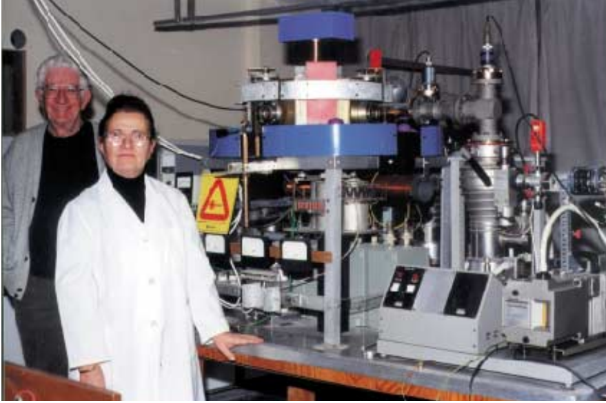
TAEK Nükleer Füzyon Laboratuvarı'nda geliştirilen STPC küresel tokamağının genel görünümü ve düzenegi geliştirilen Sinman'lar. Yalnızca 65 litre hacimli akı koruyucusuna sahip düzenek, şimdilik bir "model" sağlamanın ötesinde bir işleve sahip değil. Gene de merkezi bir mıknats çubuğuna gerek bırakmayan plazma enjeksiyonuna dayalı orijinal tasarımı, dünyada yürütülen çok daha ileri teknolojiadaki küresel tokamaklar için bir esin kaynağı. Füzyon araştırmalarında Türkiye'nin hakkı olan yere gelebilmesi için gereken, "lüks bir makam arabası" maliyetiyle, düzenegin boyutlarının üç katına yükseltilmesi. Böylelikle deney sonuçları da, "konsept" katkısının yanı sıra dünya füzyon literatürüne girebilecek. Sağda Amerika'daki NSTX küresel tokamağının merkez çubuğunun montajı görülüyor.
