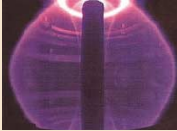
Hızlı fotoğraf tekniğiyle saptanmış 1 MA'lık tokamak şekillenmesi.
