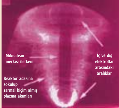
CHI plazma enjeksiyonu sırasında oluşan akım halkaları (solda). 260 kA'lık toroidal akım, 27 kA'lık CHI akımının 10 katı düzeyinde (sağda).
