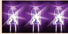
Şekil 2 : 5mm UV LED'ler
