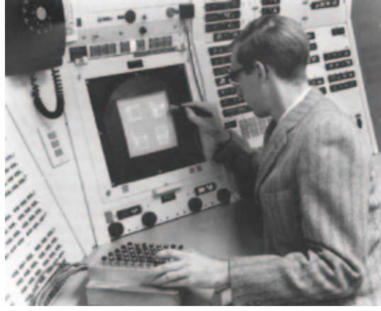
IBM tarafından General Motors için geliştirilen ilk ticari bilgisayar destekli tasarım sistemi: DAC-1
