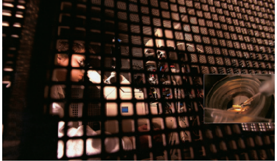
Kafes içinde ölçüm. Bir biyolog, çok hassas elektrodlar yardımıyla yabancı kabağın hücrelerindeki iyon akımlarını inceliyor. Akımlar, bitkiye dokunulması sonucunda oluşuyor ve sürgünlerin kıvrılmasına yol açıyor. Araştırmacı, elektriksel alanların ölçümleri olumsuz etkilemesini önlemek için bir faraday kafesinin içerisinde çalışıyor.
