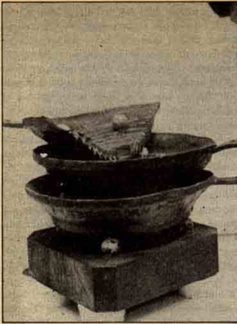
Bu 1904 yılında İsviçre’de yapılmış Triebelhorn “akümülatör”üdür. Tene-kelerin karşılıklı tarafları pozitif ve negatif materyalle kaplanmıştır, alt-taki seramik bilyalar ise izolasyon sağlamak içindir.
