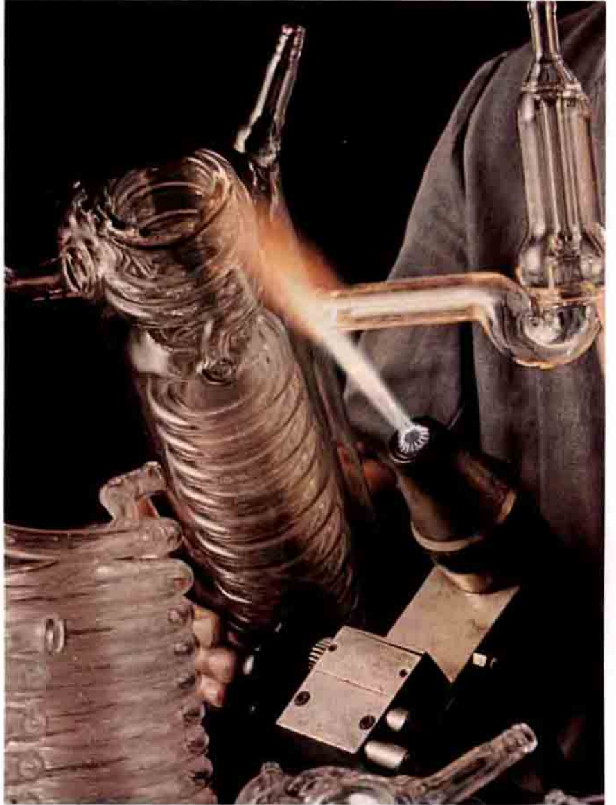
Spiralli soğutucu yapan bir cam teknisyeni görünüyor. Daha önceden ana parçaları hazırlanan soğutucu ateş yardımı ve el hüneri ile birleşiyor.
