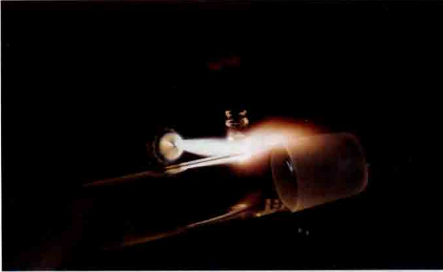
Bir soğutucunun dış silindirine açılan deliğe, hortumun bağlanabileceği boru ekleniyor. Diğer laboratuvar malzemeleri de, ateş önünde, parçalar birleştirilerek üretiliyor.
