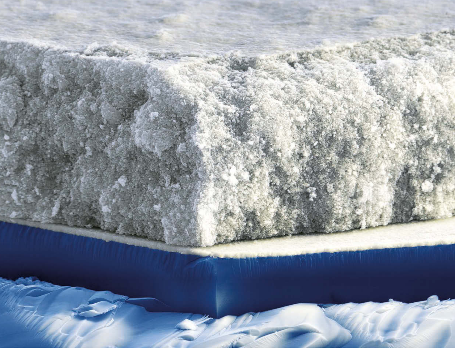
Titanyum dioksit ile kaplanmış bir fotovoltaik (güneş) pilin renkli taramalı elektron mikroskobu (SEM) ile çekilmiş görüntüsü
