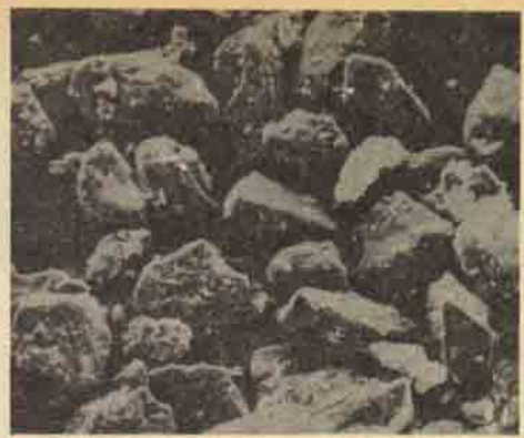
İlk defa elektron mikroskobu sayesinde fotoğraflı alınan loes parçacıkları. Resimde loes içindeki kalsiyum karbonat bileşikleri kuarz parçaları üzerinde beyaz tanecekler olarak görülmektedir. (Mikroskobun büyütmesi X 320).
