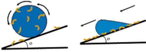
Şekil 3. Su damlası süperhidrofobik yüzey üzerinde adeta bilya gibi yuvarlanarak toz ve pislikleri temizliyor. ( \theta = kayma açısı)
