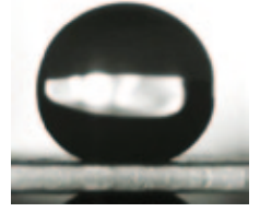
Şekil 8. Süperhidrofobik polipropilen yüzeyinin SEM görüntüsü ve süperhidrofobik polipropilen yüzey üzerinde oluşturulan su damlasının yatay görüntüsü (Erbil, H. Y., Demirel, A. L., Avci, Y., Mert, O., "Transformation of a Simple Plastic into a Superhydrophobic Surface", Science , 2003)
