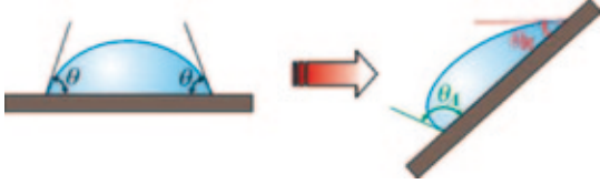
Şekil 4. Temas açısı karmaşasının şematik gösterimi ( \theta = denge temas açısı, \theta_A = ilerleme temas açısı, \theta_R = gerileme temas açısı)
