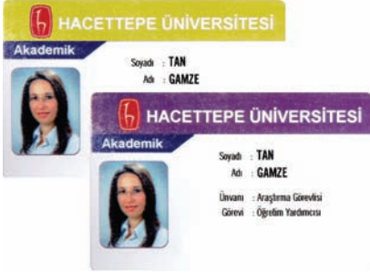
PVC ile kaplı karta ısı uygulandığında özgün mor renginin sarıya dönüşmesi
