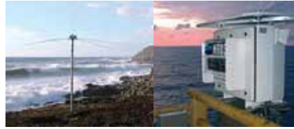
Codur okyanus algılayıcıları: SeaSonde yüksek sıklıklı radar sistemi (solda) Miros SM-050 dalga ve akıntı radarı. (sağda)
