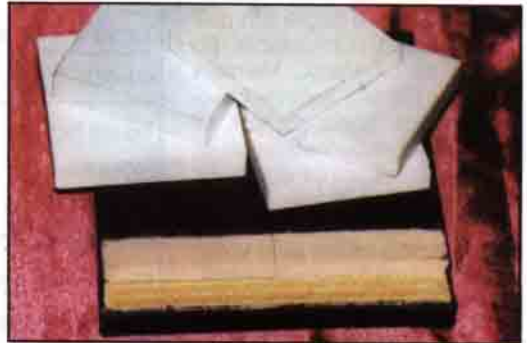
Şekil 3: Balistik amaçlı kullanılan alümina zırh seramikleri. Alümina ile kaplı balistik zırh plakasının kesiti.
