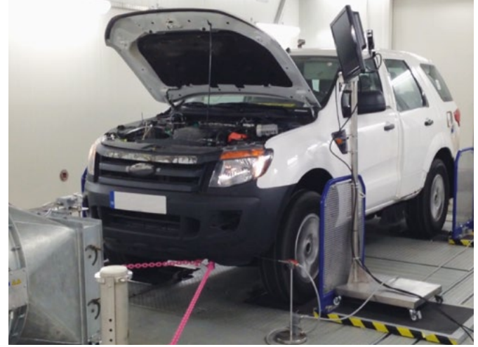
Şekil 4. Şasi dinamometresinde yapılan örnek araç testi
