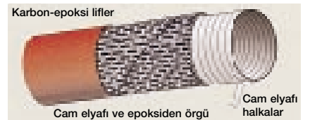
Karbon liflerinden yapılmış sırlığın kesiti Karbon-epoksi lifler Cam elyafı ve epoksidin örgü Cam elyafı halkalar
