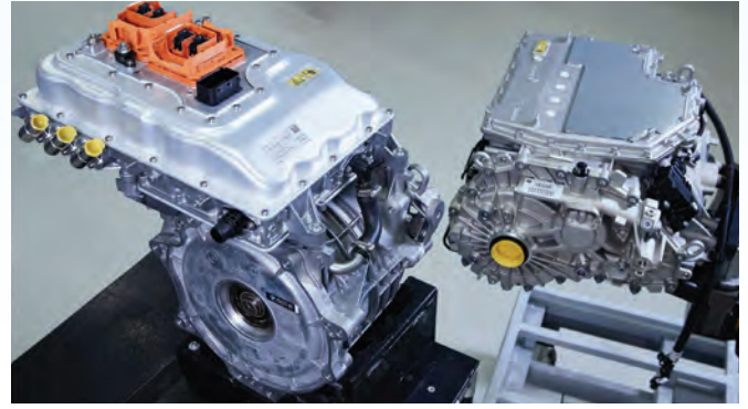
Solda BMW'nin i3'te kullandığı motor, sağda ise 5. nesil elektrik motoru. Üstelik sağdaki motorda güç aktarma organları ve elektrik sürücü devresi de mevcut.
