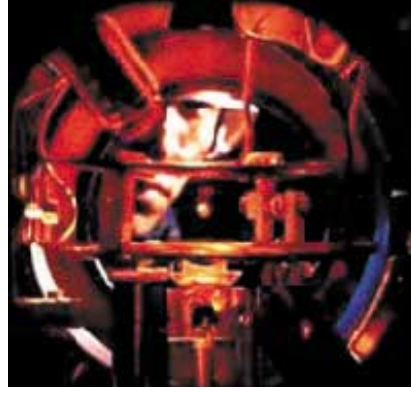
NIST çalışanı Kris Helmerson magneto-optik olarak tuzaklanmış ve 1 milikelvin'e kadar soğutulmuş sodyum atomlarını (vakum çemberinin merkezindeki sarı nokta) gözlemliyor.
