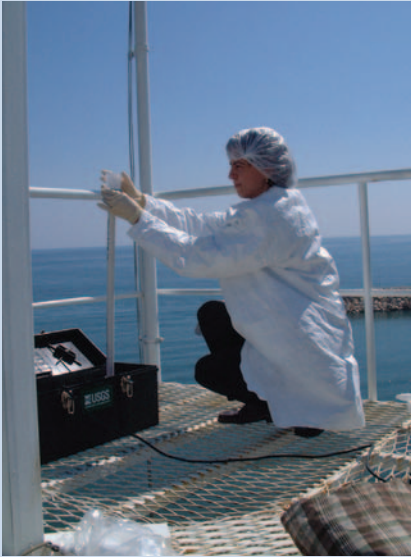
Aerosollerin mikrobiyolojik içeriğini (bakteri ve mantar sayımları için) belirlemek için kullanılan numuneler kulinin tepesindeki cihazlardan alınır.
