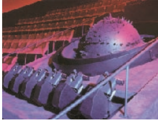
Spitz firmasının ürettiği büyük projektörlerden Space Voyager ve yıldız projektöründen detay. Spitz, farklı olarak, her yıldız için ayrı mercek kullanıyor.
