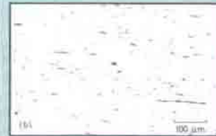
Şekil 3: Mızrak ucu (I-85-45) nun mikroyapısı. (a) Sap kısmı, enine kesit, (b) Sap kısmı, boyuna kesit. Her iki mikrograftaki siyah fazlar, kalıntıları göstermektedir. (c) Ağız kısmı (Mikrograflar: N.BOZKURT).
