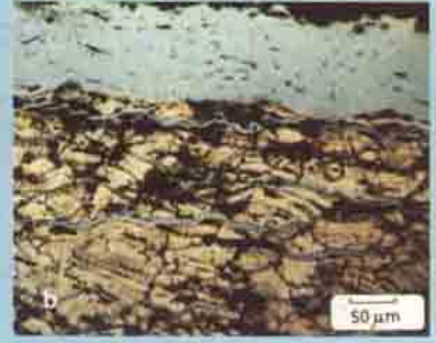
Şekil 2: (a) Mızrak ucu (I/84-241) nun sap kısmının mikroyapısı. Mavi renkteki faz, arseniğe zengin Cu_3As bileşimini, zemin ise bakırca zengin fazı göstermektedir (enine kesit). (b) I/81-352 No'lu etütlük buluntuda, korozyon tabakasının hemen altında yer alan mikroyapı.
