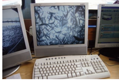
Açık denizde yapılan yetiştiricikte yemleme otomatik olarak yapılıyor. Ayrıca sualtı kameralarıyla da balıkların yem alıp almadığı devamlı izleniyor. Balık yem almayı bıraktığı anda yemleme de durduruluyor.
