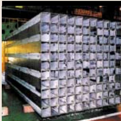
Bor katkılı paslanmaz çelikten yapılmış profiller, nükleer santrallerde kullanılmış yakıt çubuklarının daha büyük miktarlarda depolanabilmesini sağlıyor.
