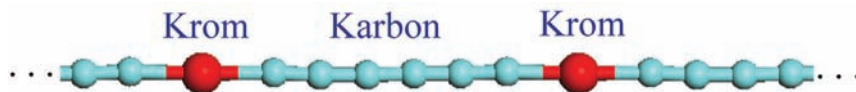
Şekil 6: Karbon ve krom (veya kobalt) atomlarının periyodik olarak dizilişleriyle oluşturulan atom zincirleri "yarım metal" özelliği göstermektedir.
