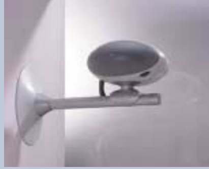
TeraBeam firmasına ait duvara monte edilen bir FSO cihazı.
